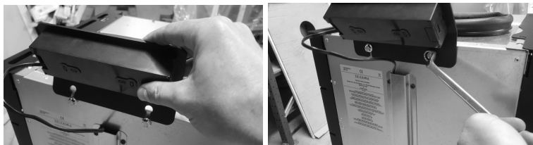
Figura 16 – Fixação do display
