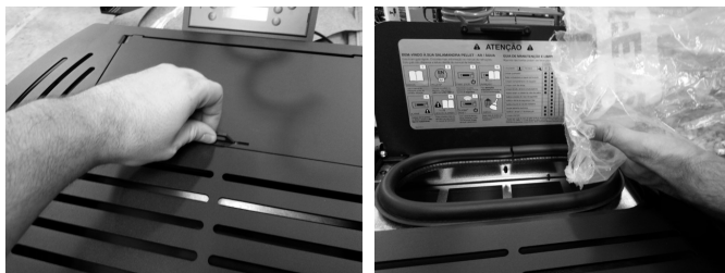
Figura 17 – Abastecimento do depósito de pellets
